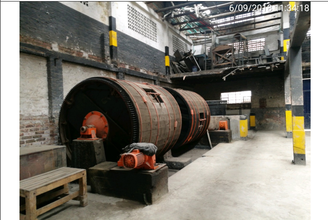
Foto No. 3 Bombos de proceso
